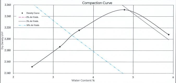
Test Methods Notes Compaction NZS 4402 : 1986 : Test 4.1.3
